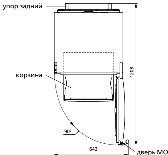
Рисунок 2 – Холодильник (вид сверху)
